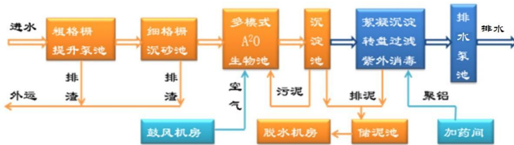
图 4-2 新城区污水处理厂处理工艺流程图
